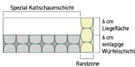
Schematische, technische Illustration eines Matratzen-Ausschnitts
